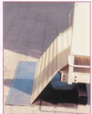
▲ Gleitfläche für die Rampe
